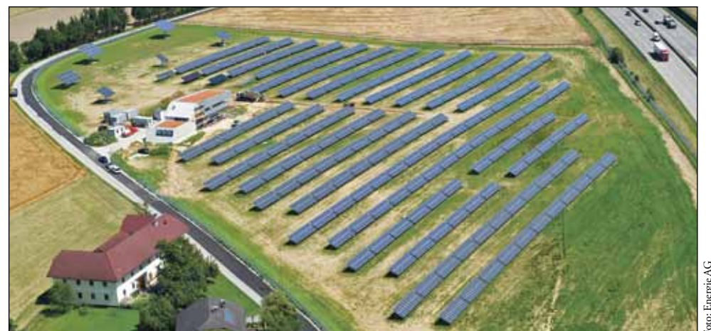
Nicht zu übersehen: An der Autobahn A1 bei Eberstalzell in Oberösterreich liefert eine Photovoltaikanlage mit 8.000 m² pro Jahr bis zu 1.000 MWh Strom ins Netz.
