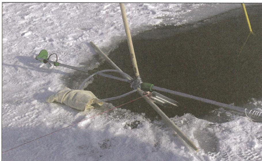
Mittels einer „Gasmaus“ wird das Gas der Kochbrunnen aufgefangen und anschließend im Labor auf seine Zusammensetzung hin analysiert.
