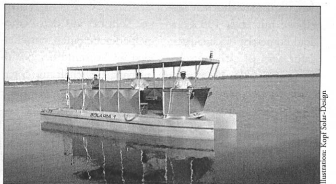
Die Photovoltaikzellen auf dem Dach liefern den Strom – bei Bedarf kann über die Steckdose „nachgetankt“ werden.
