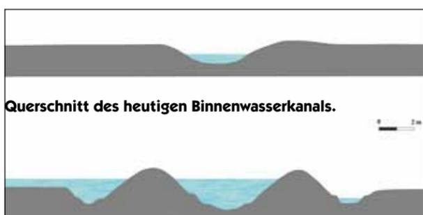
Rekonstruierter Querschnitt desselben Kanals aus der Árpádenzeit.
