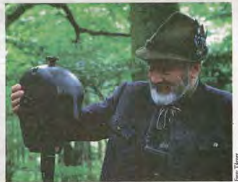
Kunstkopf-Stereomikrophone, hier eines im Bild mit Walter Tilgner, nehmen Geräusche naturnah auf.
